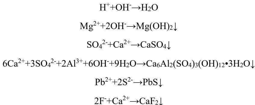
在实际生产过程中要根据实际淋洗水中镁离子、硫酸根离子和重金属离子浓度，动态调整投入的中和沉淀药剂的量。“中和+沉淀”处理废水的工艺，属于成熟技术上，是可行的。
